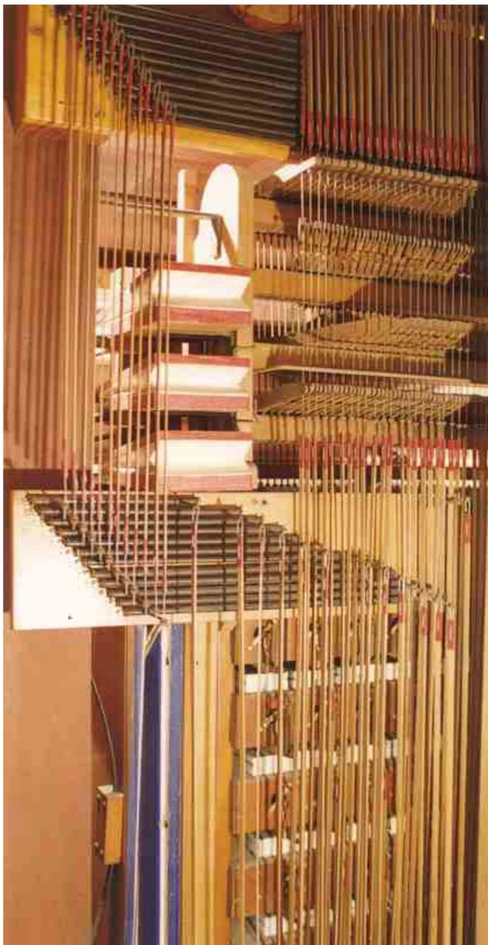
*Fotografía 7. Máquina de asistencia neumática y acoplamientos.*
